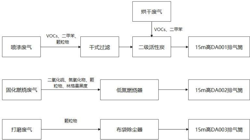
图 4.1-1 环评设计阶段废气处理措施（1）
