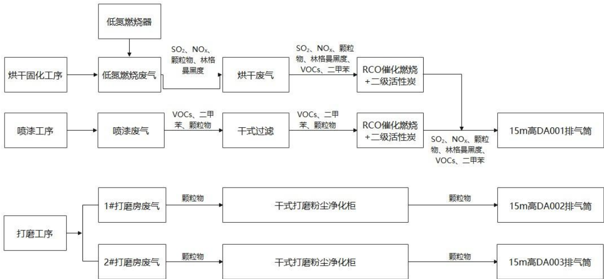
图 4.1-1 环评设计阶段废气处理措施（1）
